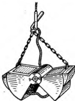
Рис. 2.4. Дночерпатель Петерсена (модифицированная модель).
